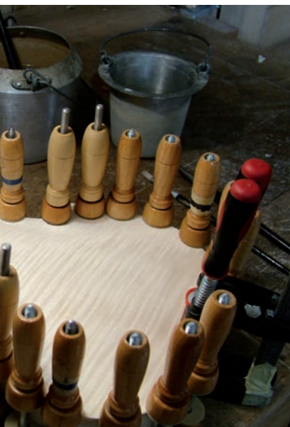
Incollaggio di un fondo di violino alle fasce in acero marezzato tramite colla naturale di origine animale
