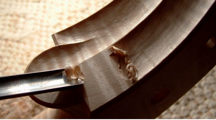
Sgusciatura del dorso di una testa di violoncello in legno di acero mazzato
