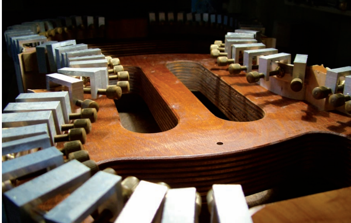
Incollaggio delle controfascie in salice alle fasce di violoncello tramite l'utilizzo di morsetti a "C"
